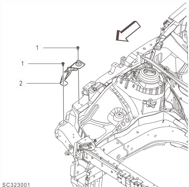
2. 安装前翼子板托架的2个固定螺栓拧紧到9 Nm，并检查扭矩。
